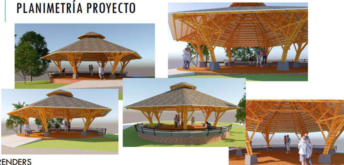
Ilustración 32 Construcción del kiosko en guadua del Jardín Botánico
